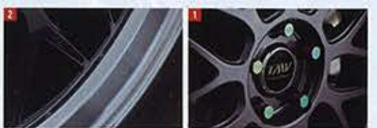
1 センター部分は大きく落とし込んだ形状。スポーティな味付けだ。2 リムは深度もしっかり。10J×20インチなら71mmと迫力満点。3 段付き形状リムに、ピアスポルト。マルチピース感も楽しめる。
